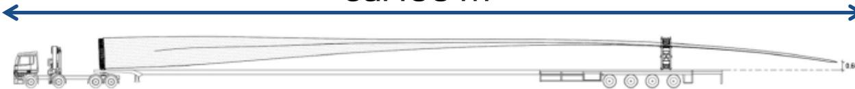
Abbildung 17: Beispiel für den Transport des Rotorblattes
